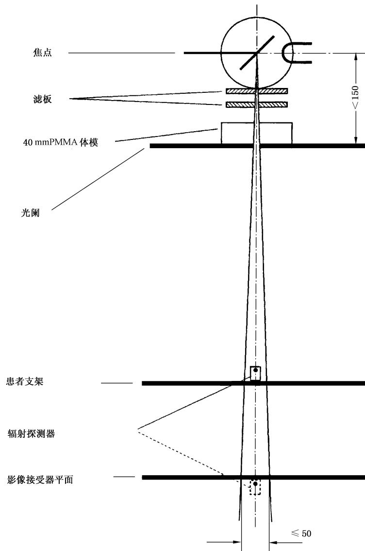
图 2 衰减率测量设置
